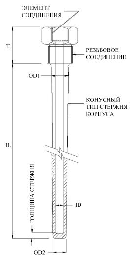
OD 1 - наружный диаметр 1; OD 2 - наружный диаметр 2; ID - внутренний диаметр.
